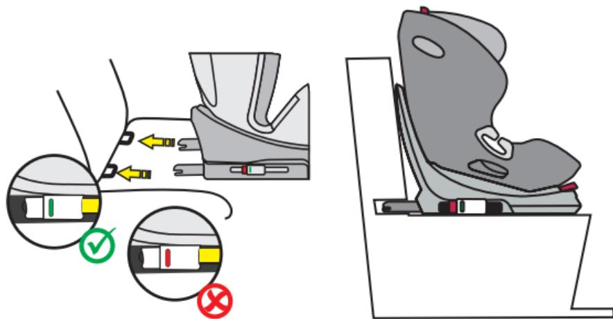
1. Druk de Isofix-connectorknoppen aan beide kanten in om de Isofix-connectoren in de lengte uit te schuiven.
