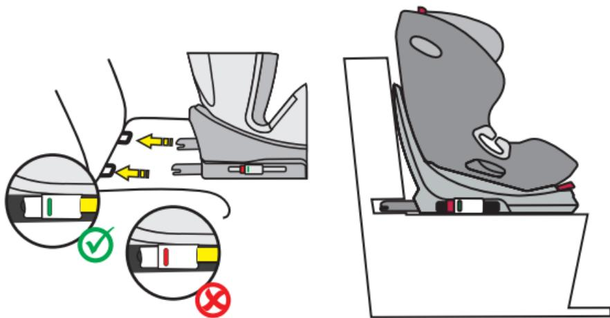
1. Pulse los dos botones laterales del conector Isofix para ampliar la longitud de los conectores Isofix.
